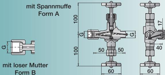
mit Spannmuffe und Prüfanschluss nach DIN 16272-Form A
